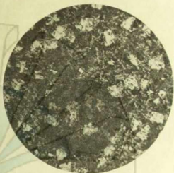
F.O. E. Figuur 21. × 100 Eén maal omgesmolten. Doorsnede midden in de proefstaaf met kogelindruk.
