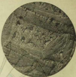
M. F. No. 1 × 100 Figuur 18. Mengsel D I. Koper-antimoon 38.6 % Cu. Sb-Cu 2 β Kristallen en eutecticum van 25 % Cu.
