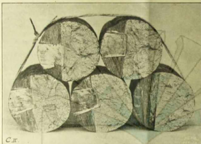
Figuur 4. Smeltling Cn, \pm \frac{1}{2} , der ware grootte. Lood-antimoon 17,7 %, Sb. Breukvlakken vertoont aan den rand vrij antimoon.
