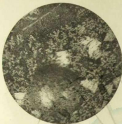
F.O. D. × 100 Figuur 16. Doorsnede in het midden van de staaf. Normaal veld met kogelindruk onder: Sb Cu 2 arm metaal met Sb Cu 2 kristal.
