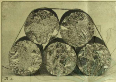
Figuur 6. Smelting D I, \pm %, der ware grootte. Koper-antimoon 38,6 % Cu. SbCu_2 \beta met eutecticum SbCu_2 + Sb.
